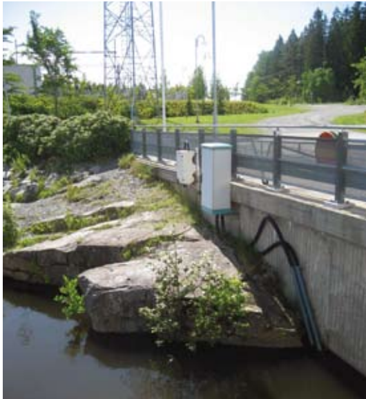
Kuva 4. Vedenlaatatiedot tallentuvat Äetsässä voimalaitoksen patorakenteisiin kiinnitettyyn seuranta-asemaan (vas.). Mittausaseman sisällä näkyy YSI 600 OMS-moniparametrimittari (oik.) (Kuvat: Jonna Konsala 2.7.2008; Luode Consulting Oy)
