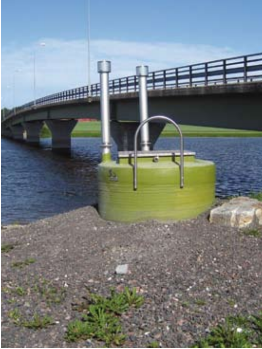
Kuva 3. Automaattinen seuranta-asema tallentaa tiedot Kokemäenjoen vedenlaadusta Karhiniemessä (vas.). Näytteenotto tapahtuu YSI 6600 EDS moniparametrimittarilla (oik.) ja S::Can-mittauslaitteella (oik.). (Kuvat: Jonna Konsala 2.7.2008; Luode Consulting Oy)
