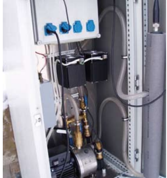
Kuva 4. Vedenlaatatiedot tallentuvat Äetsässä voimalaitoksen patorakenteisiin kiinnitettyyn seuranta-asemaan (vas.). Mittausaseman sisällä näkyy YSI 600 OMS-moniparametrimittari (oik.) (Kuvat: Jonna Konsala 2.7.2008; Luode Consulting Oy)
