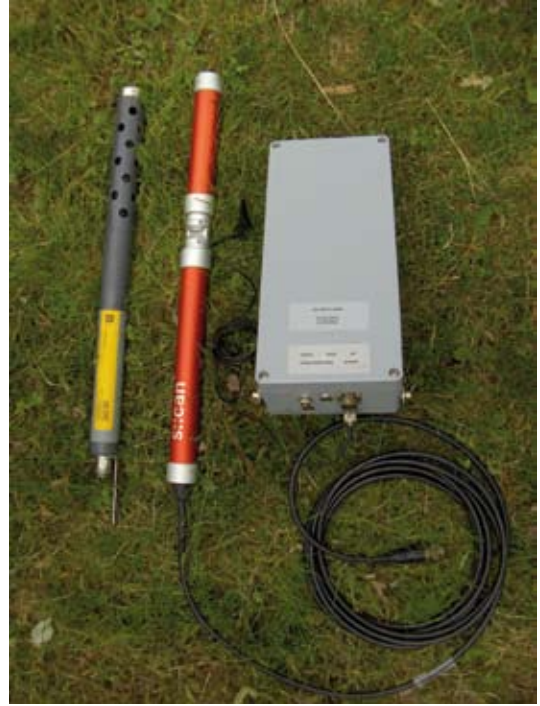
Kuva 3. Automaattinen seuranta-asema tallentaa tiedot Kokemäenjoen vedenlaadusta Karhiniemessä (vas.). Näytteenotto tapahtuu YSI 6600 EDS moniparametrimittarilla (oik.) ja S::Can-mittauslaitteella (oik.). (Kuvat: Jonna Konsala 2.7.2008; Luode Consulting Oy)
