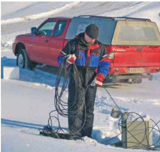
Kuva 20. Pohjaveden laadun mittausta moniparametrimittarilla putkesta 365. Kuva: Jorma Paavola.
