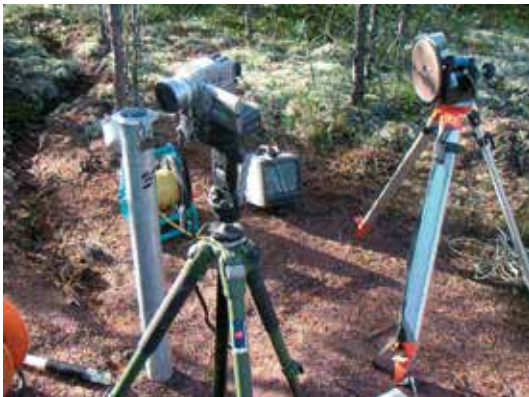
Kuva 12. Pohjavesiputken videokuvauslaitteisto. Kuvassa vasemmalla maassa näkyy videokamera, joka lasketaan reikään kuvassa oikealla näkyvän laskulaitteen avulla.
