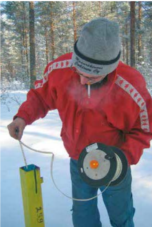
Kuva 17. Vedenpintojen käsimittausta. Mittaajana Turun Seudun Vesi Oy:n kenttäimestari Jorma Paavola.
