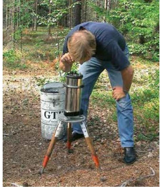
Kuva 14. Kuvassa painovoimamittausta Virttaankankaalla elokuussa 2003. Kuvassa näkyvä mittalaite on gravimetri. Kuva: Juba Kääriä.
