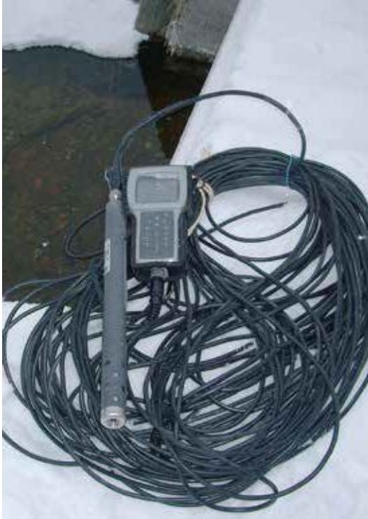
Kuva 19. Suoraan pohjavesiputkesta tapahtuvaan vedenlaadun mittaukseen soveltuva vedenlaadun moniparametrimittari.
