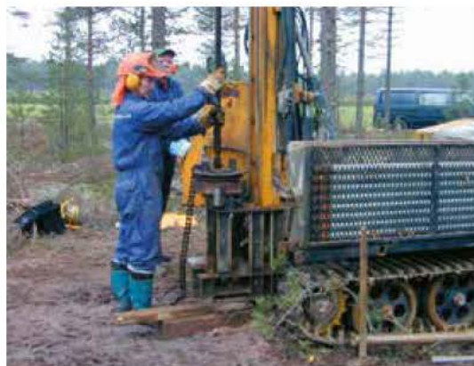
Kuva 6. Porakonekairauskalustoa. Kuva: Juha Kääriä.
